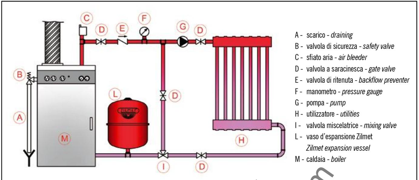
■ esempi di dimensionamento | sizing examples
